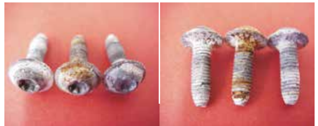
Vis sans traitement EJOSEAL Corrosion après test de tenue au brouillard salin 456h selon DIN50021 (Zinc 8µ blanc)
